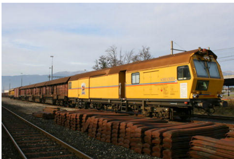
Train meuleur de rails (Scheuchzer S.A.)
